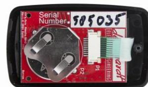
**Atención:** Utilice solo una pila de botón de litio CR2430 como pila de repuesto.
